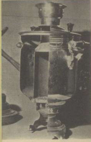
برش داخلی سماور ، دو طبقه را نشان میدهد ، طبقه زیرین كه برای استفاده چای است و طبقه فوقانی كه جهت قرار دادن آتش ، تمبیه شده و آب را به جوش می آورد .
